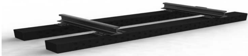
Рис. 1. Трёхмерная модель для расчёта на прочность композитных шпал
