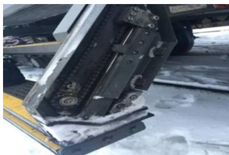
Рис. 3. Обледенение цепи привода и накопление снега в кожухе четвертой ступени
