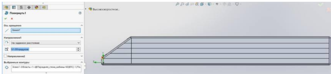
Рис. 2. Модель ВСНТ с углом наклона кабины машиниста 39°
