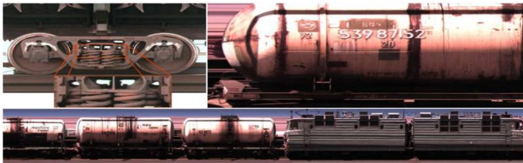
Рис. 2. Создание детализированного панорамного изображения поездов посредством применения линейных видеокамер
