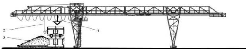
Рис. 2. Предлагаемая технология выгрузки щебня на ООО «ТЕХКОМПЛЕКТ» Условные обозначения: 1 – вибрационный разгрузчик; 2 – трос с люкоподъемником; 3 – отвал
